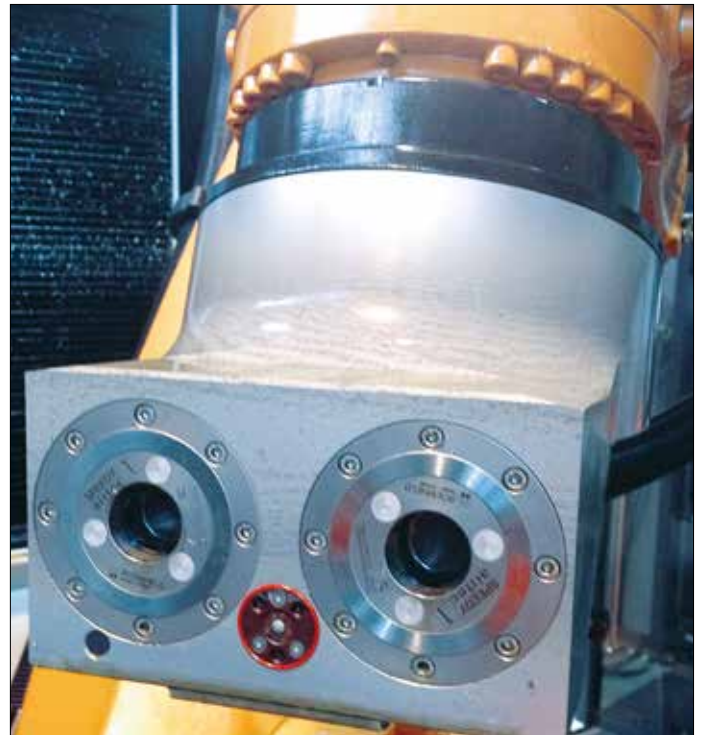
Beispiel: Greifer für Roboter mit pneumatischer und elektrischer Kupplung
