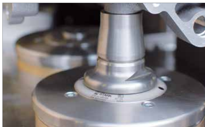
Patentiertes positionsflexibles Spannelement in x/y/z-Richtung
