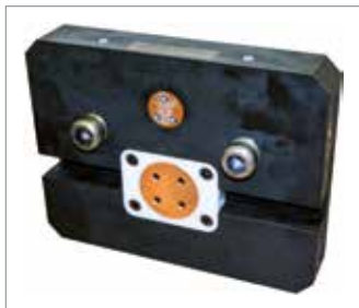
Beispiel: Greifer und Greiferplatte für Roboter mit Multimedienkupplung und galvanisch getrenntem Massepol.
