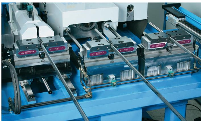
Sistemi di bloccaggio dei pezzi ZH durante l'utilizzo
