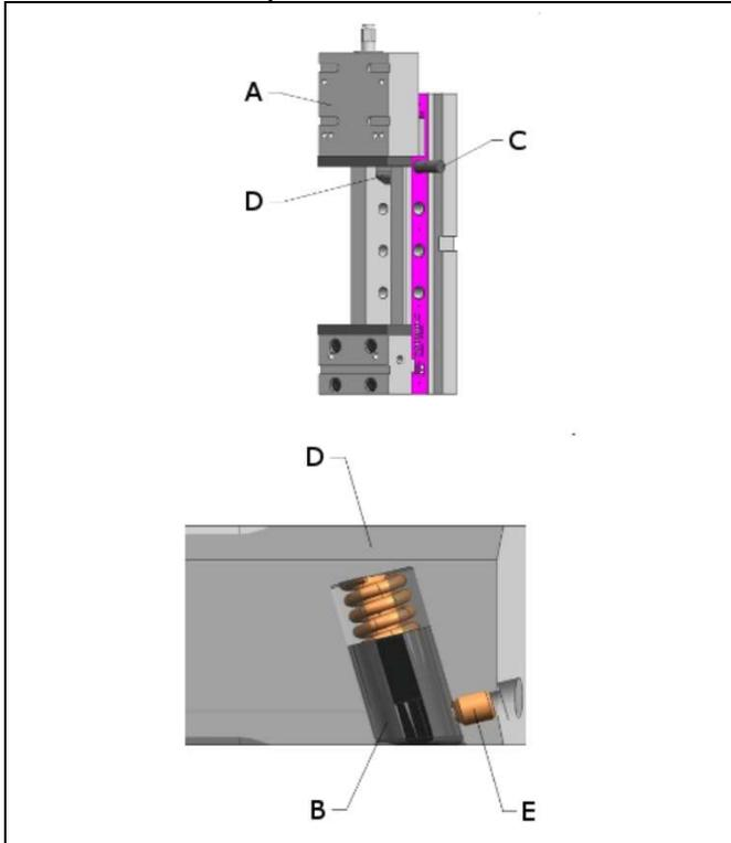
Abb. 5: Bremse für Spannschlitten BB 100 und BB 125
