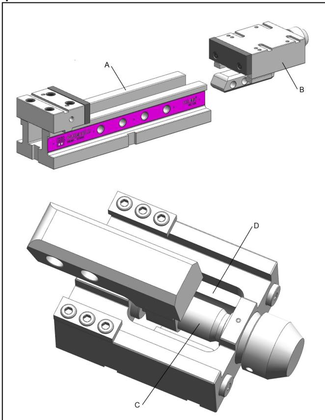
Abb. 6: Spannschlitten demontieren
