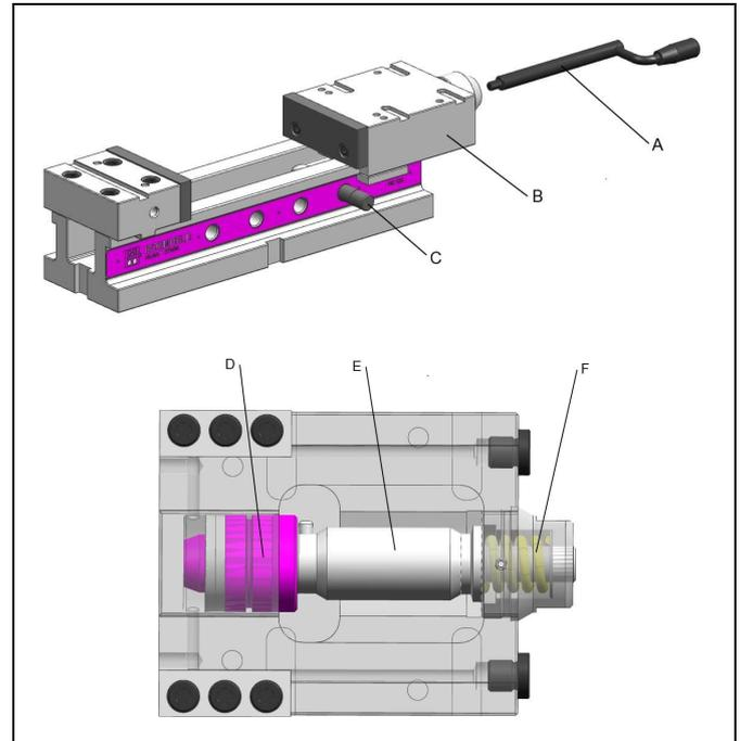
Abb. 1: Komponenten für Baureihe NC
