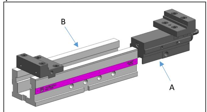
Regelmäßig den Spannschlitten (A) vom Unterteil (B) abnehmen, reinigen und die Gleitflächen ggf. abziehen und einölen.
