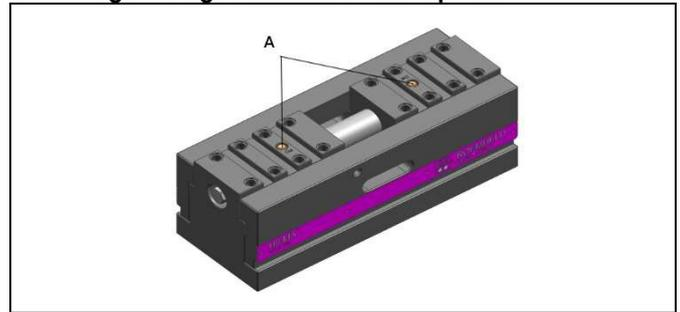
Abb. 3: Schmieren der Spindel über Schmiernippel (A) für Typ 100 + 125
