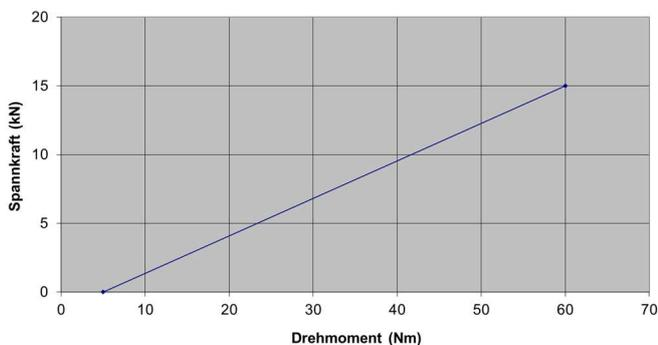
Spannkraftverlauf MC-P 100/125
