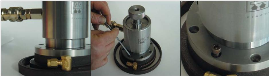
Entfernen aller Schrauben des Schnellspannzylinders mittels Innensechskantschlüssel SW4.
