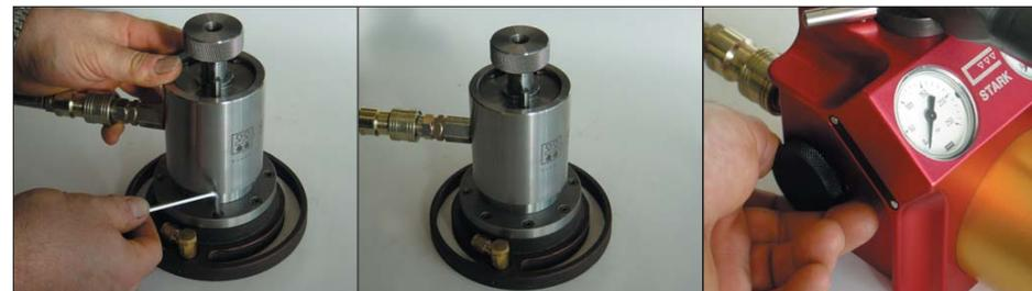
Festziehen aller Schrauben, danach Druck ablassen.
