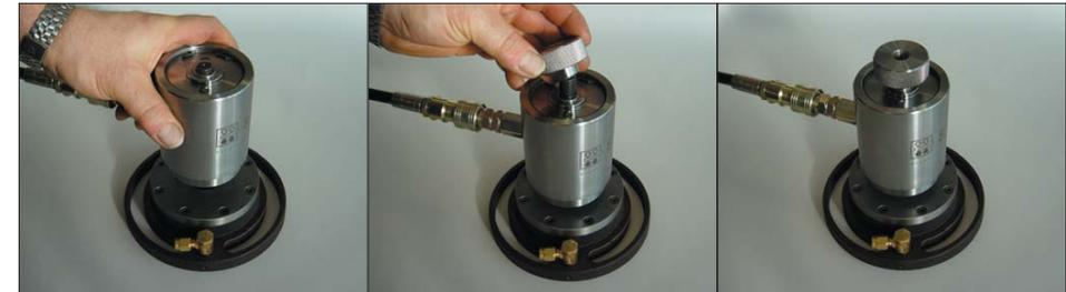
Aufsetzen der Montagehilfe
