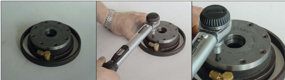
Nachziehen aller Schrauben mit dem Drehmomentschlüssel.
