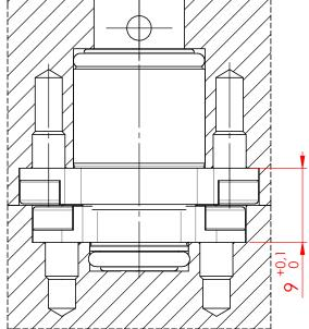
Das Maß A ist so zu wählen, dass im zusammengebauten Zustand der Abstand zwischen den Auflageflächen der Kupplungen 9mm 6 Kanten gebrochen 0,1x45° oder R0,1 beträget (siehe Einbauvarianten)
